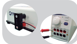
③ 位置合わせガイドにそって上部電極板をセットし、専用リード線で電源装置と接続します
